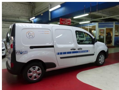
Ce véhicule électrique a un prolongateur d'autonomie avec pile à combustible à hydrogène. ©Mairie de Paris, DILT
